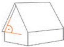
Neigungswinkel eines Daches
